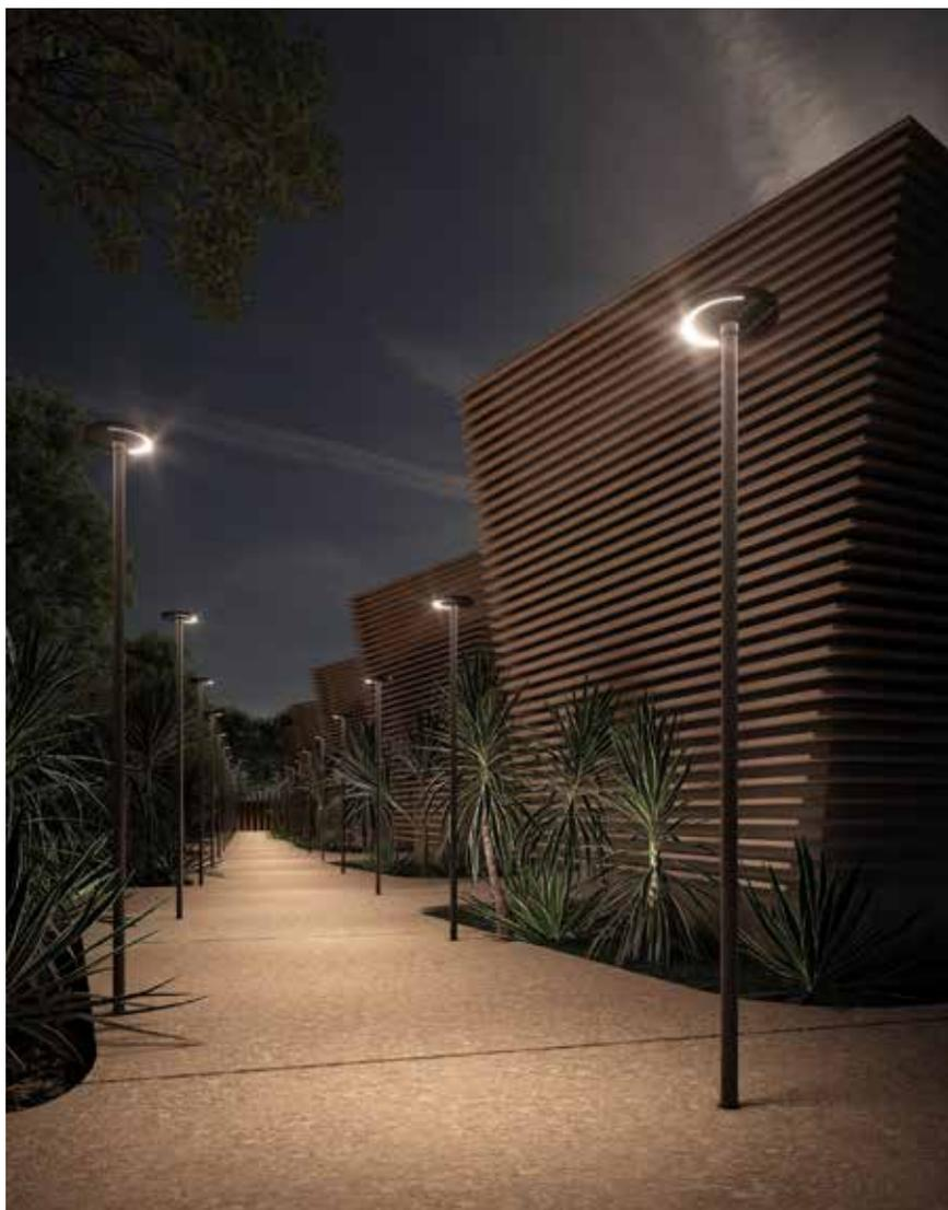
Tête de mât LED, forme ronde avec diffusion de la lumière sur 180° ou 360°. IP65. Températures de couleur : 2200K / 2700K / 3000K / 4000K. Dimmable. Traité bord de mer. Pré-câblé. IK08. IRC>80. Durée de vie L90B10 60 000h. Recommandé pour l'installation sur des poteaux métalliques de Ø60. Ne convient pas aux Still poteaux.
