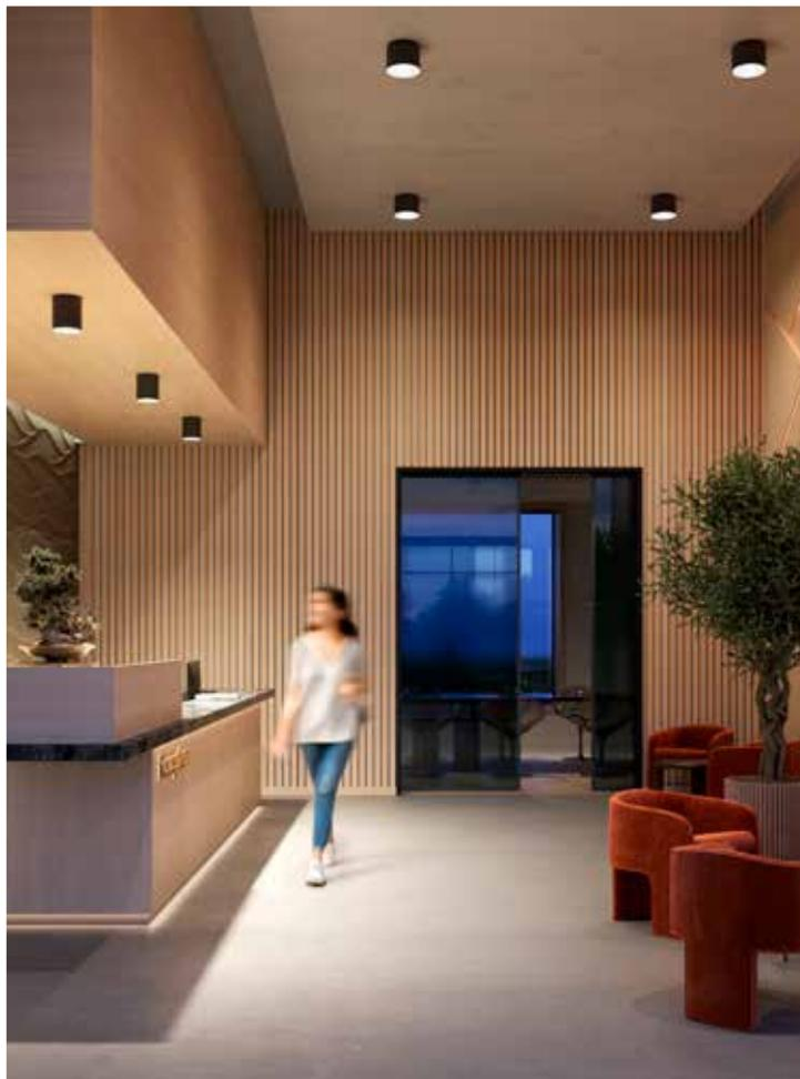
Plafonnier LED R150 (module LED interchangeable et convertisseur), IRC>90. 4000K. Tolérance de la couleur (MacAdam initial) : 2. Puissance du luminaire : 8,3 W. Flux lumineux 1090 lm, 131 lm/W. Durée de vie L90 100 000 h. Luminaire pilotable via DALI (uniquement) avec fonction DC, réglable de 1 à 100 %, niveau de l'alimentation de sécurité préréglé sur 15 %, configurable avec NFC, compatible SwitchDIM. IP20. Raccordement : bornier 5 pôles à enfichage.
